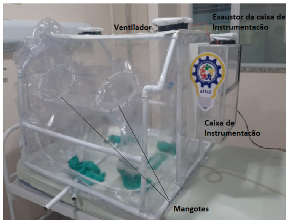
Figura 2- Estrutura com a perspectiva do mangote para procedimento médico.
